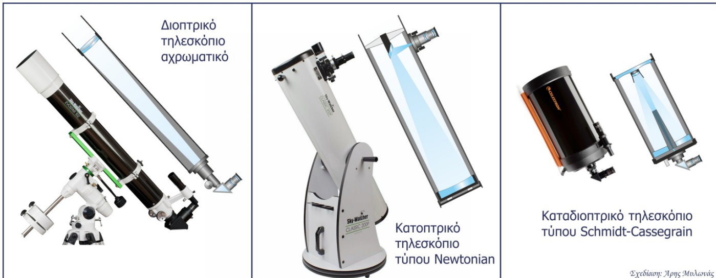
Οι τρεις κύριες κατηγορίες τηλεσκοπίων, ανάλογα με τον οπτικό σχεδιασμό τους.
