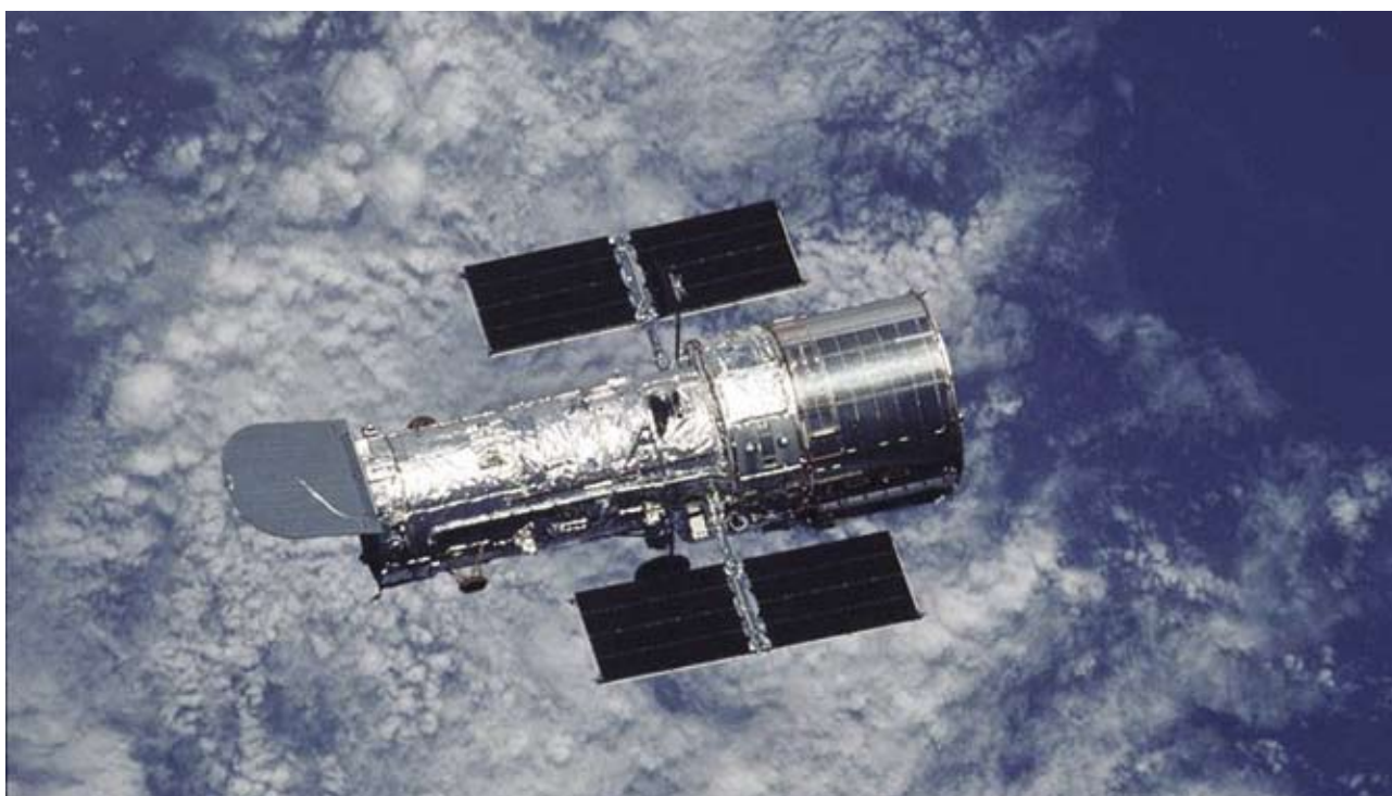
Εικόνα 5. Το διαστημικό τηλεσκόπιο Hubble, σε απόσταση 560 Km πάνω από τη Γη, τέθηκε σε τροχιά το 1990. Το πρωτεύον κάτοπτρό του έχει διάμετρο 2.4μ. © STScI
