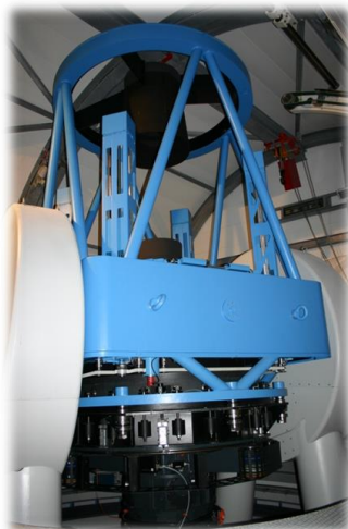
Το τηλεσκόπιο «ΑΡΙΣΤΑΡΧΟΣ». Το κινούμενο μέρος του που ζυγίζει περίπου 40 τόνους μπορεί να στοχεύει με απίστευτη ακρίβεια (λίγα δευτερόλεπτα της μοίρας) τα ουράνια αντικείμενα.
