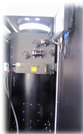
Τηλεσκόπιο και οπτική διάταξη εκπομπής laser ακτινοβολίας στο υπεριώδες, ορατό και υπέρυθρο
