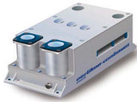
Εικόνα 2. Η μονάδα καταγραφής ενεργειακών σωματιδίων SREM
